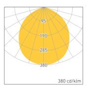
5.1 EFICIENCIA DEL SISTEMA: 60 lm/W @ 3000K 63 lm/W @ 4000K 68 lm/W @ 4000K
